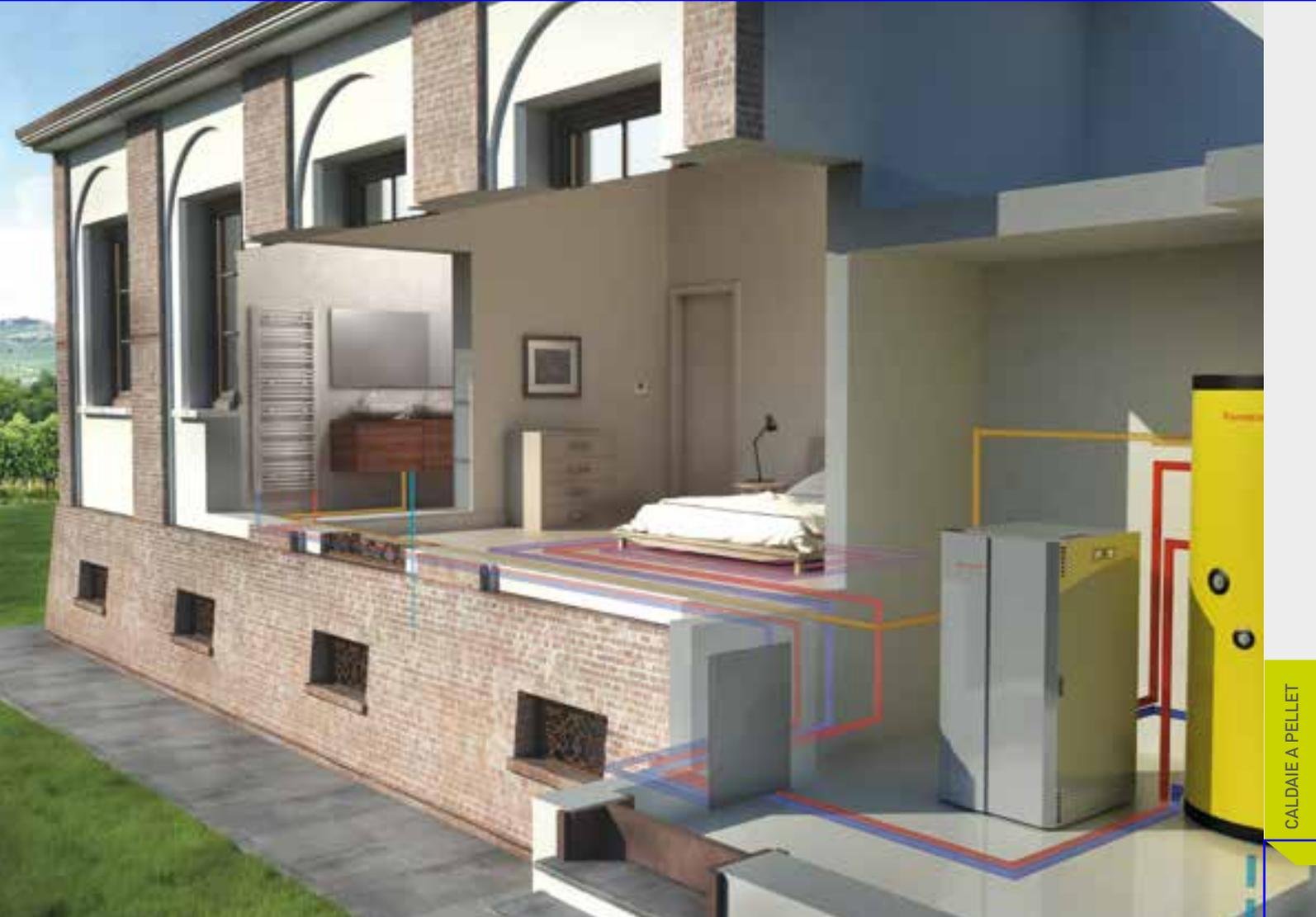
**La nuova gamma di caldaie a pellet LUXOR** affianca l'offerta di Immergas nel novero di soluzioni che integrano l'utilizzo di fonti di energia rinnovabile. L'utilizzo del pellet come fonte di energia per il riscaldamento e la produzione di acqua calda sanitaria è sicuramente un'**ottima opportunità** in molte zone d'Italia ed inoltre questi apparecchi beneficiano anche degli incentivi del **Conto Termico 2.0**.
